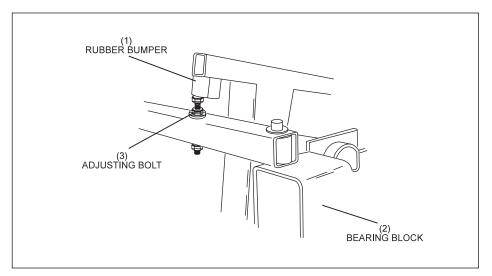
Figure 6-6. Ball Cushion Adjusting Bolt.
